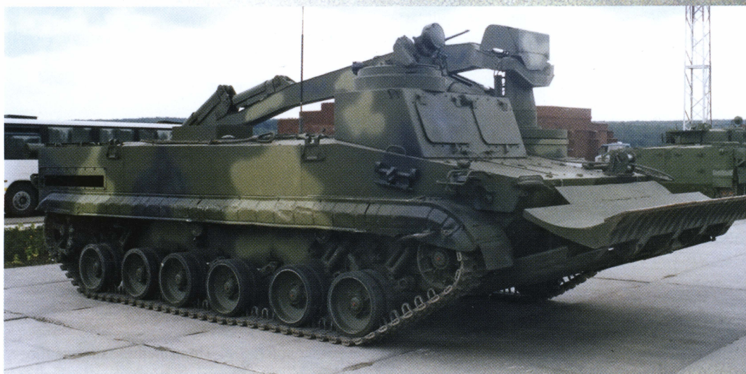
Авиатранспортабельная дорожно-землеройная машина «Восторг», созданная на базе БМП-3.
