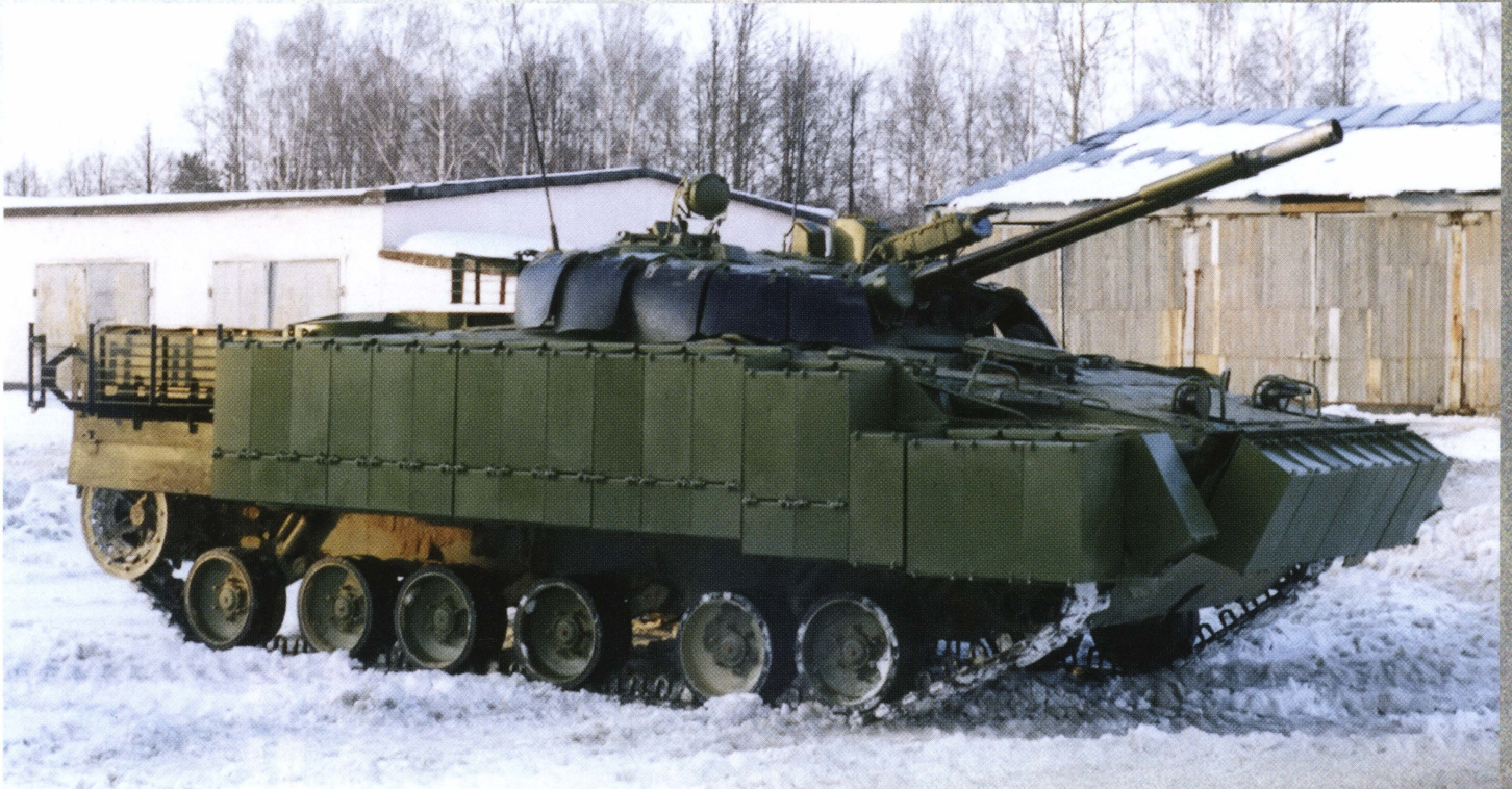
БМП-3, оснащенная комплексом навесной динамической защиты, вид справа.
