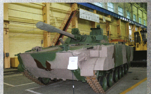
БМП-3 с дополнительными бортовыми противокумулятивными экранами.
