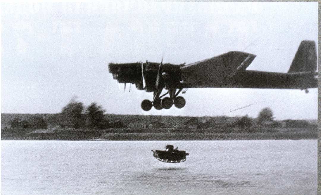
Момент сброса танка Т-37А с самолета в воду, октябрь 1936 года.
